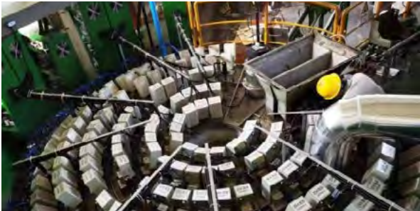
电加热实现铁矿石造块
